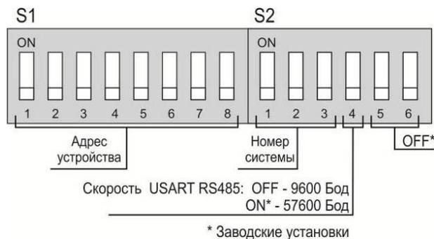
Рисунок 17 – Ретранслятора Р-433. Расположение переключателей.
