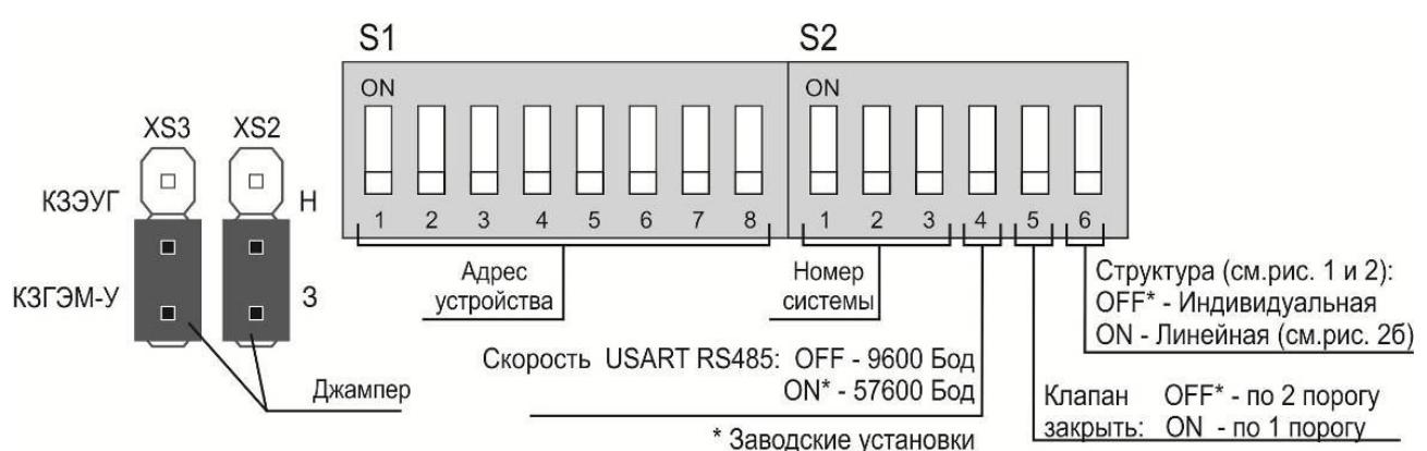
Рисунок 4 – Назначение переключателей и перемычек.
