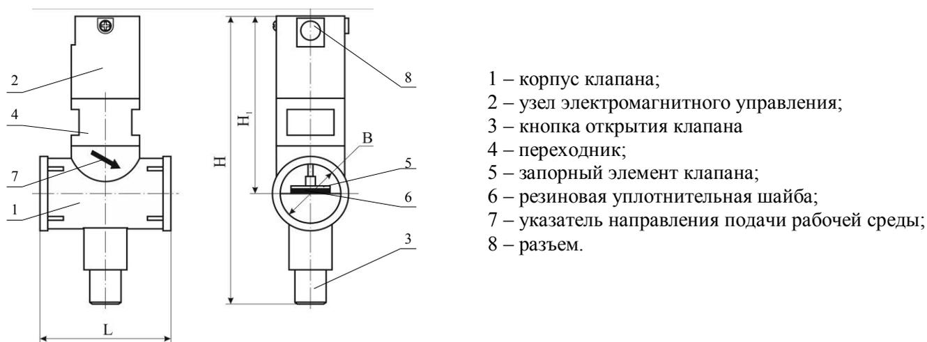
Рисунок 6 – Внешний вид клапана КЗЭУГ.
