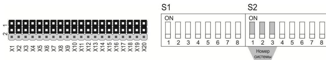
Рисунок 14 – БСУ-КС. Расположение перемычек и переключателей
