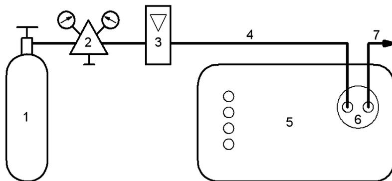
1 – баллон с ПГС, 2 – редуктор, 3 – ротаметр, 4 – трубка ПВХ 5x1,5 мм,
