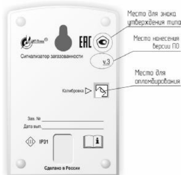
Рисунок 3 – Схема пломбировки от несанкционированного доступа и место нанесения знака утверждения типа
