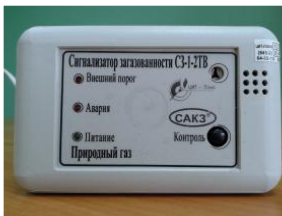
Рис.1 Фотография общего вида сигнализатора загазованности природным газом с оптическим сенсором СЗ-1Т.
