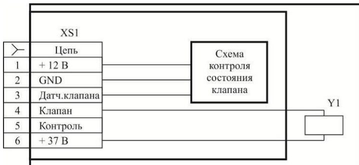
Рисунок 8 – Клапан КЗГЭМ-У. Схема электрическая принципиальная.
