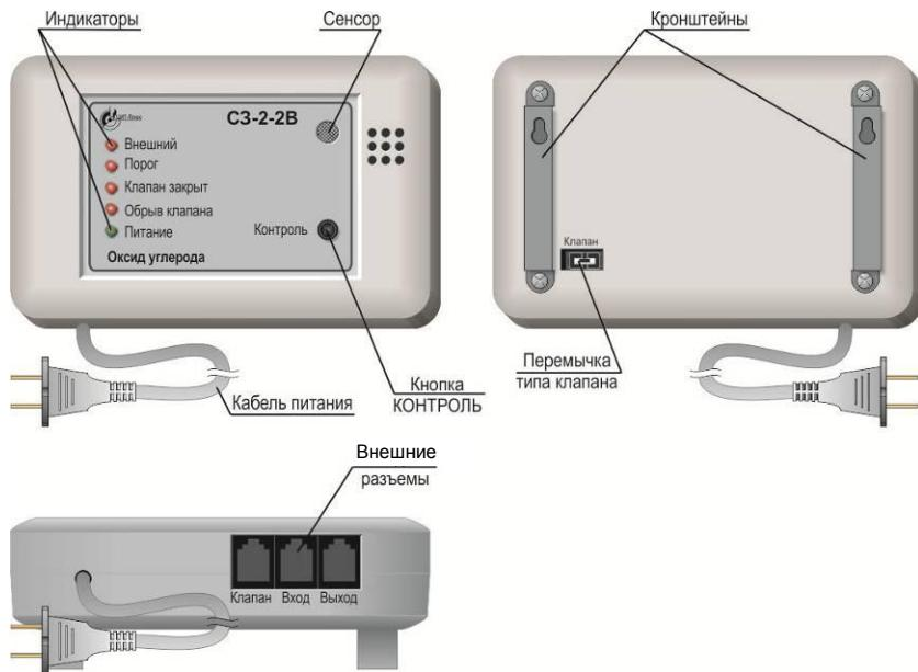
Рисунок 3 – Внешний вид сигнализатора С3-2-2В
