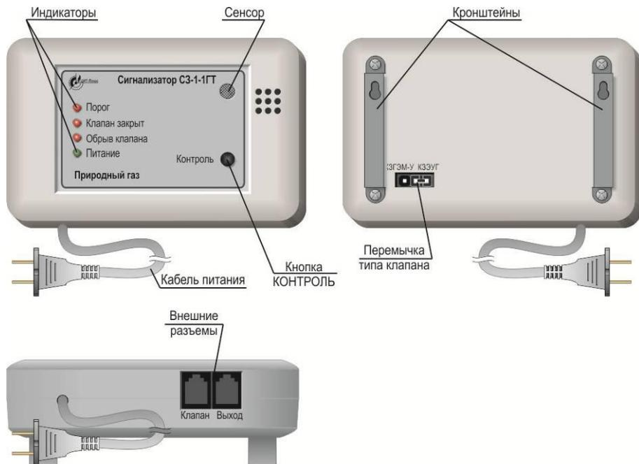
Рисунок 2 – Внешний вид сигнализатора С3-1-1ГТ
