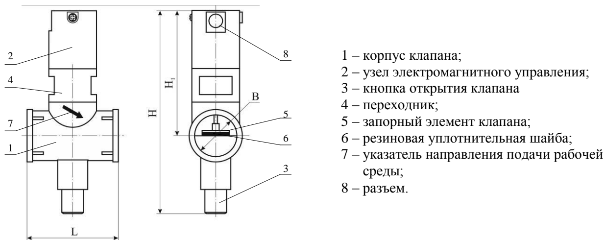
Рисунок 6 – Внешний вид клапана КЗЭУГ.
